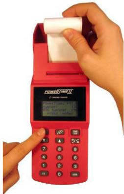
Tout en appuyant sur la touche d'avance papier, introduire la nouvelle bande de papier dans la fente d'introduction de l'imprimante. Pousser doucement le papier jusqu'à ce que le mécanisme d'avance commence à le saisir. Appuyer sur la touche d'avance papier
