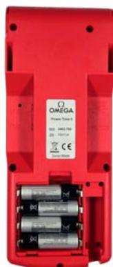
Introduire quatre piles neuves (ne jamais remplacer uniquement quelques piles, toujours les 4 en même temps) en respectant les polarités indiquées dans le fond du logement
