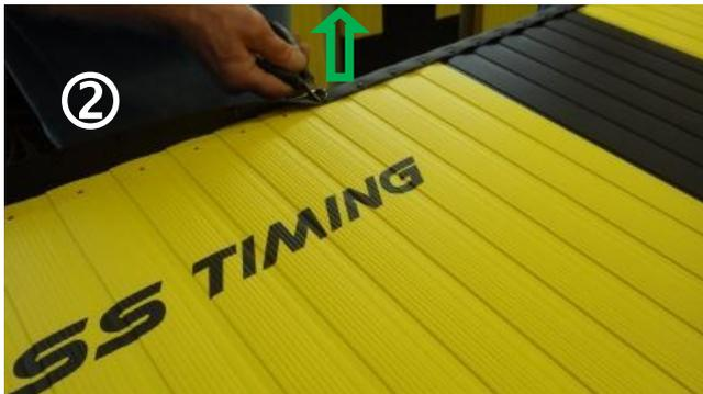
Figure 18 - Maintenance / Remplacement de la bande de contact II
